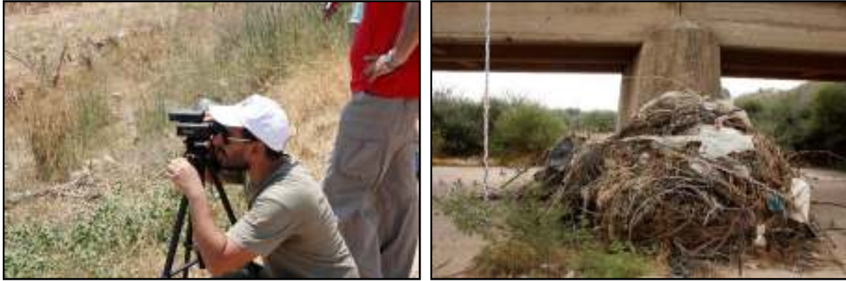
Εικόνα 4.13. Εργασίες πεδίου για τις μετρήσεις των γεωμετρικών χαρακτηριστικών τόσο των υδραυλικών έργων αλλά και της φυσικής κοίτης των ρεμάτων που εκβάλουν στο πεδινό τμήμα της περιοχής έρευνας.
